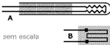
Na figura ao lado, esboços dos dois tipos comuns de RTD: em A o **RTD de fio** (o fio metálico é enrolado em forma de espiral dentro de um tubo cerâmico com suportes e outros detalhes não mostrados). Em B o **RTD de filme** (um filme metálico é depositado sobre uma placa de cerâmica). Na prática, o RTD de filme é também colocado no interior de um tubo para proteção. Ambos são desenhos sem escala.
